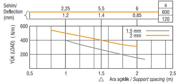
Yük taşıma kapasiteleri belirlenirken kablo kanallarının N/m olarak ağırlıkları dikkate alınmalıdır. / When determining the load capacities the unit weights (asper N/m) of the cable trays should be considered.
